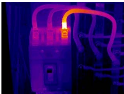
Conexión floja o deteriorada
